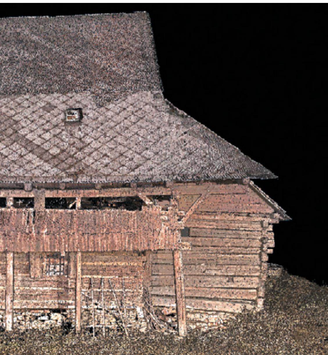
17. Prostorový model roubeného domu z Trstěnice, obarvené mračno bodů, 2015, vypracoval J. Kmošek. Three-dimensional virtual model of the timbered house from Trstěnice, coloured transparent point cloud. Raummodell vom Blockhaus aus Trstěnice, farbig gefasste Punktwolke.
