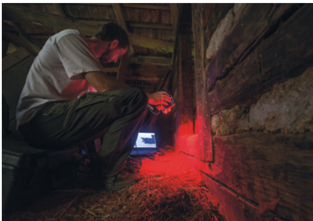
1. Skenování ostění dveří ručním laserovým skenerem Exa Scan™, 2015, foto J. Kmošek. Door jambs scanned by manual laser scanner Exa Scan™. Abtasten der Türstoc-kes mit dem handgeführten Scanner Exa Scan™.
