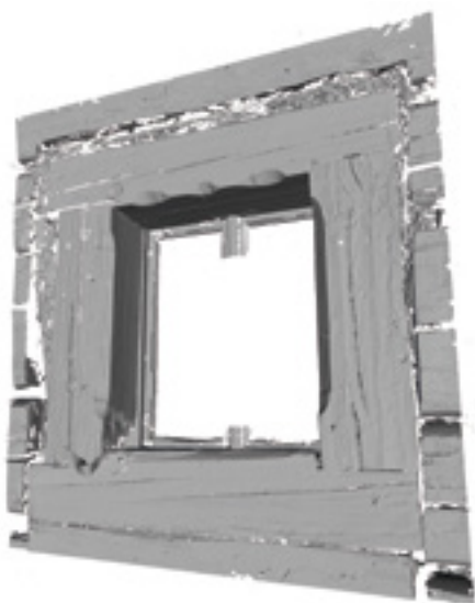
2. 3D model dřevěné okenní zárubně tvořený polygonovou sítí, 2015, vypracoval J. Kmošek. 3D model of the window frame in the form of a traverse net. 3D-Modell des gezimmerten Fensterstockes, bestehend aus einem Polygonnetz.
