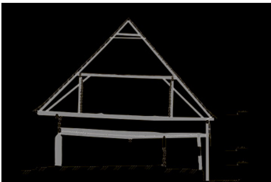
21. Vektorová dokumentace příčného řezu roubeným domem z Trstěnice vytvořená z prostorového modelu, 2015, vypracovala I. Kociánová. Vectorial documentation of a longitudinal section of the timbered house from Trstěnice created on the basis of the three-dimensional virtual model. Vektorzeichnung des Längsschnitts durch das Blockhaus aus Trstěnice, entworfen aus dem Raummodell.
